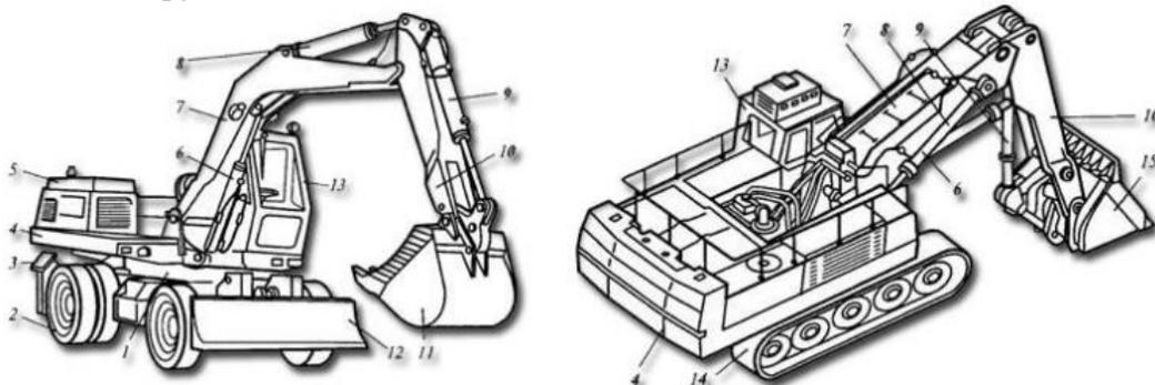
**Рис. 4.1. Одноковшовые гидравлические полноповоротные экскаваторы с жесткой подвеской рабочего оборудования:**
